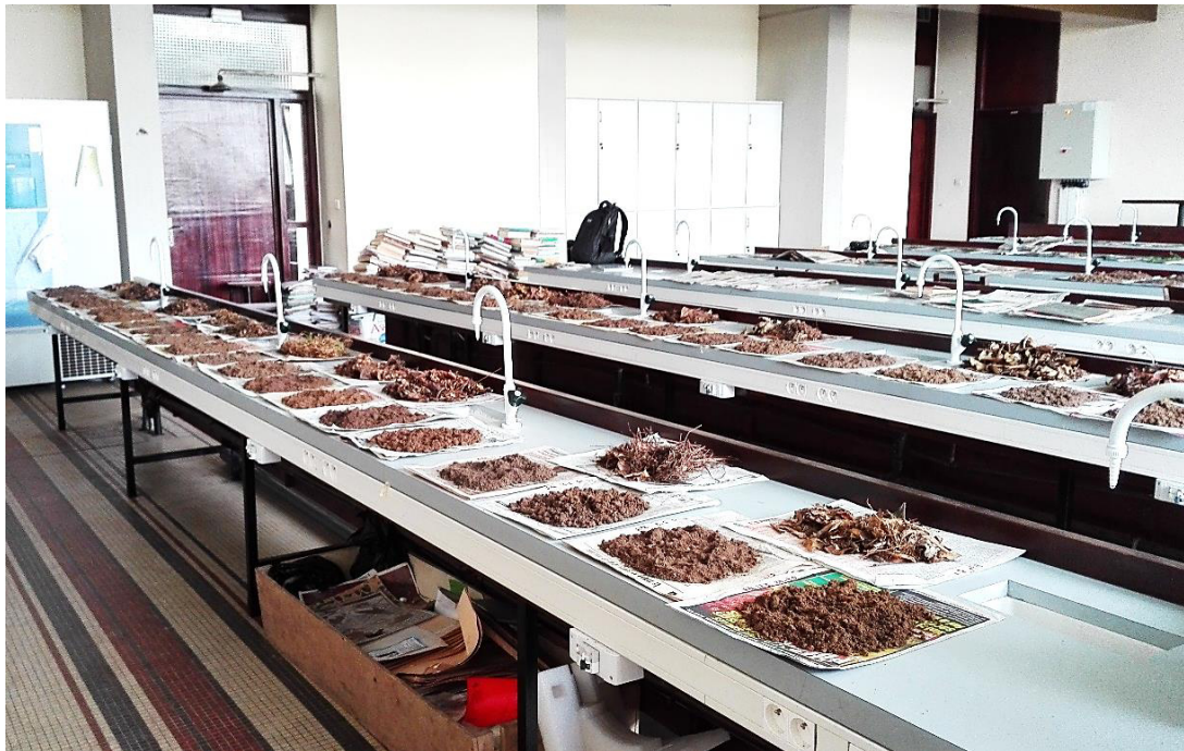
Figure 31 : Vue des échantillons de sol, séchés au laboratoire
