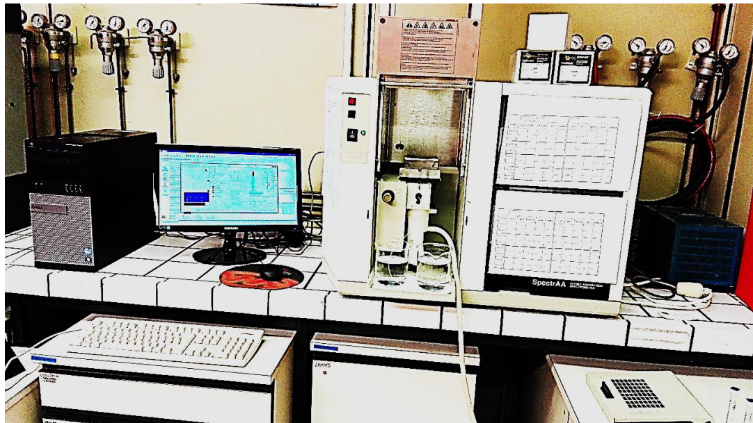
Figure 21: Dispositif d'un spectromètre d'émission atomique par Plasma Induit
